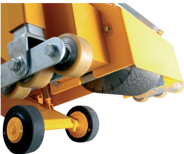
Fräswelle des CF-245 mit bis zu 400 mm Fräsbreite, höhenverstellbarer und arretierbarer Stützrollenblock für exakte Frästiefeneinstellung
